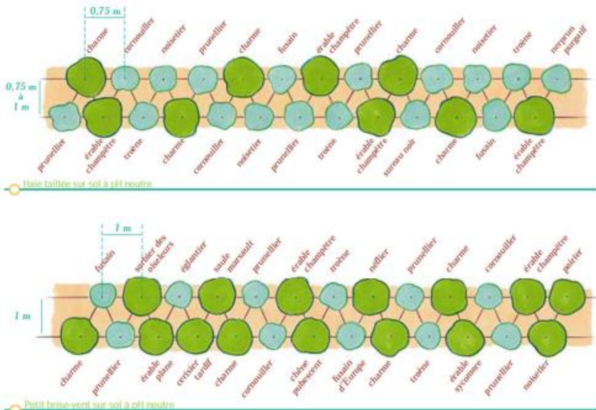
Figure 7 : Principes de plantation d'une haie taillée et d'une haie dense petit brise-vent (Conseil général du Rhône, 2003)
